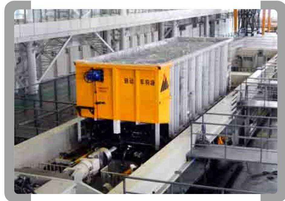
公司拥有国家认可产品试验室，是中国和亚洲唯一一家符合 UN 标准的集装箱冲击试验定点单位，具有世界最先进的集装箱冲击试验线、车箱一体疲劳与振动试验台、大部件疲劳试验台、集装箱型式试验台。通过开展集装箱疲劳、装载加固、敞车工况、角件性能等试验和研究，掌握了设计和制造核心技术，为产品可靠性和技术创新提供强有力支撑。
