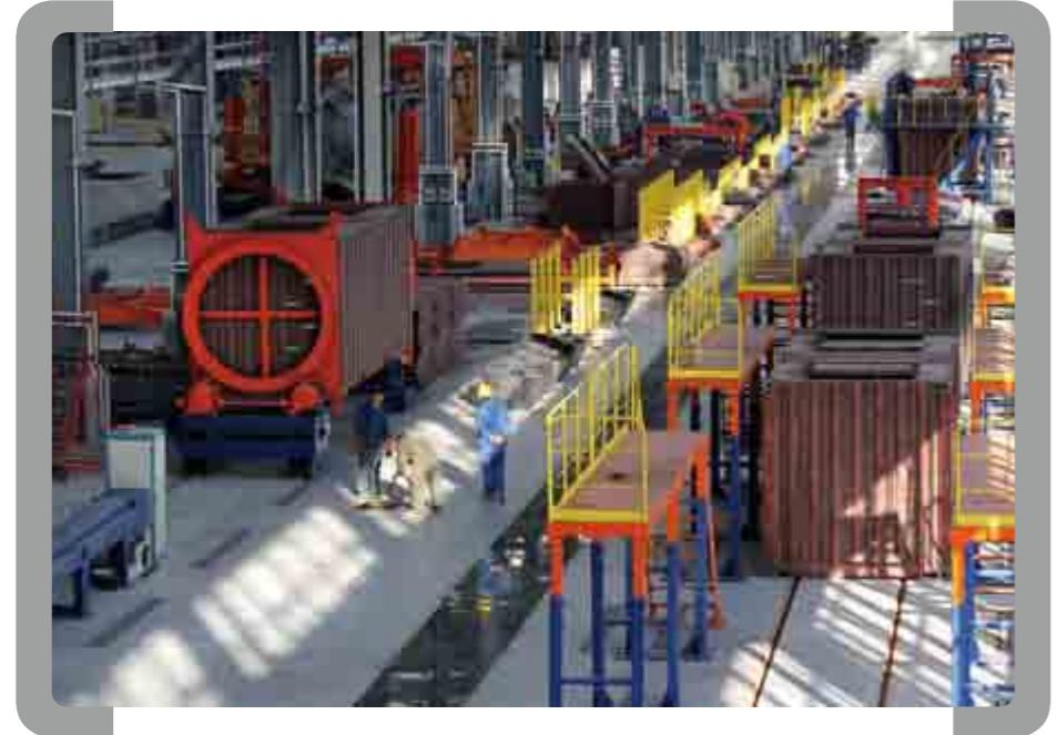
集成组对、焊接和检验为一体，拥有专业化的碳钢罐箱、不锈钢罐箱、LNG、干散货箱、杂型箱与检修箱等五条生产线。配备了罐式集装箱、LNG、干散货箱等部件和整箱柔性化组对装备，以及不离线翻转机、整箱抛丸机、LNG 绕线和烘干室、油漆喷涂生产线；配备了适应埋弧焊、气体焊、等离子等焊接方式的板材拼接、筒体纵焊缝、筒体环焊缝等自动化焊接装备和除尘系统；配备了角柱拉力、X 射线探伤、罐体水压和气密性、整箱试雨、氦质谱检漏、抽空等智能化的试验和检测装备。
