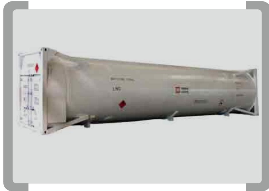
液化天然气罐式集装箱，属于三类压力容器，主要用于运输和存储低温液化天然气，采用专用的装卸货口进行装卸作业。该箱采用真空多层绝热结构配有安全阀、三通切换阀、泄压装置、气动紧急切断装置等，保证货物的运输安全。
