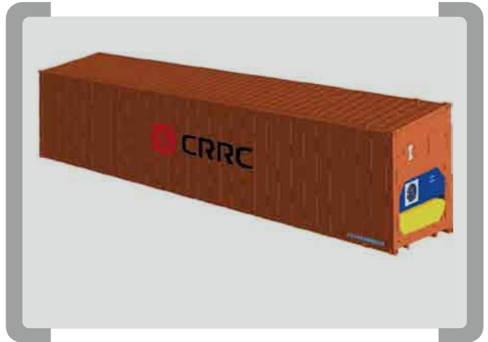
主要用于公路、铁路运输冷冻或冷藏产品，满足铁路运输及公路挂车运输工况，箱体主要承载结构采用钢制焊接结构，底部设有鹅颈。制冷机组采用成熟的柴电一体机械制冷机组，箱内温度范围可控制在 CARRIER-29°C 到 +29°C，TK-29°C 到 +27°C，保温层采用新型复合材料，大大提高整箱保温性能，实现节能降耗。该箱配有智能监控系统，满足本控和远程控制及主要信息的远程监测功能，使运输环节更有保障。
