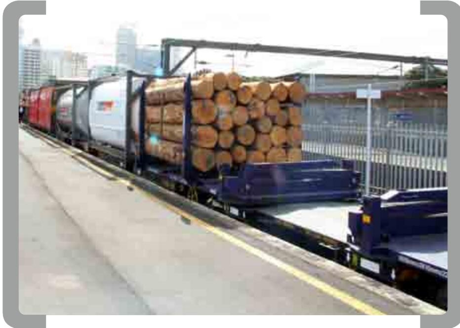
主要用于运输木材、管材等，使用时两台一组，成对使用，与集装箱平车配合使用。采用可折叠端侧墙结构或用可折叠侧柱结构，空箱返运或存放时可折叠堆码，降低运输成本，节约存储空间，综合经济效益高。
